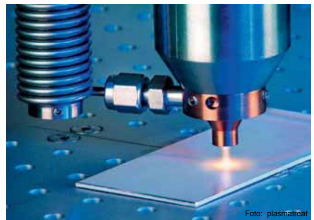
Plasmapolymerbeschichtung eines Aluminiumbleches
